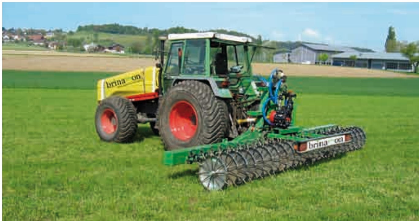
Injecteur à roue avec tracteur et réservoir d'engrais.
