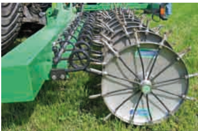
Roue d'injecteur pour l'application ponctuelle d'ammonium dans les cultures à rangs serrés et les prairies. Les raccords d'injection en forme d'étoile sont fermés à leur extrémité. Le liquide sort par des ouvertures latérales au moment où les tubes pénètrent dans le sol. Grâce à une fixation pendulaire et une compression à ressort des agrégats individuels, une profondeur régulière est assurée.
