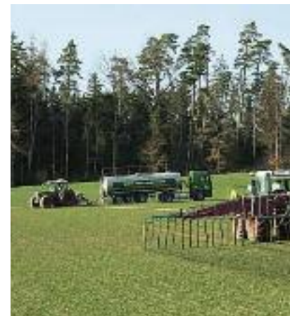
Die Verschlauchung mit Schleppschlauchverteiler erfolgt direkt ab LKW.
