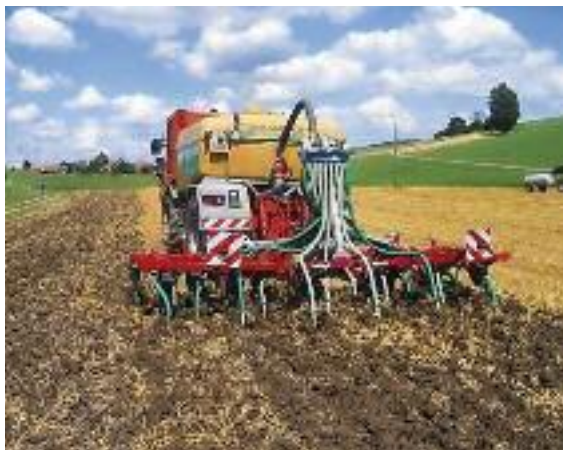
Für die emissionsarme Ausbringung im Ackerbau wird ein Holmer mit Güllegrubber eingesetzt.
