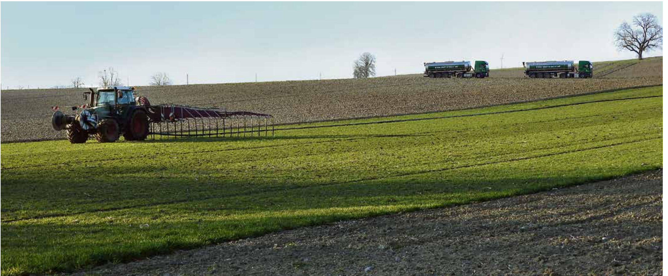
Das Güllefass bleibt am Feldrand, das Gerät am Traktor mit Schleppschauchtechnik wird über einen Schlauch bedient.
