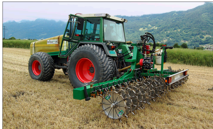
Mit dieser Maschine wird Stickstoff mit dem Cultan-System ausgebracht. (Bild: Beat Thuner)
