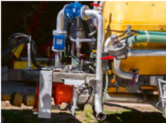
Die von der orangefarbenen Pumpe angesaugte Gülle wird im Bypass-Verfahren mit dem Zusatzstoff aus dem Tankfass angereichert. Oben (blau) ist ein Rückschlagventil angebracht.
