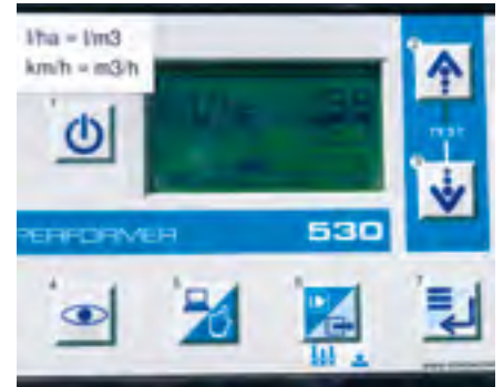
Die Steuerungseinheit, auf der die Dosierung eingestellt wird und der aktuelle Durchfluss abgelesen werden kann.
