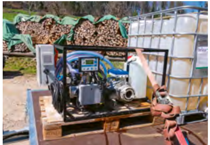
Mobile und einfachere Lösung auf einem PKW-Anhänger – versorgt mit Strom aus der Steckdose oder von einem Generator. Die Zusätze werden hier aus Plastik-Tanks dem Güllestrom beigegeben.
